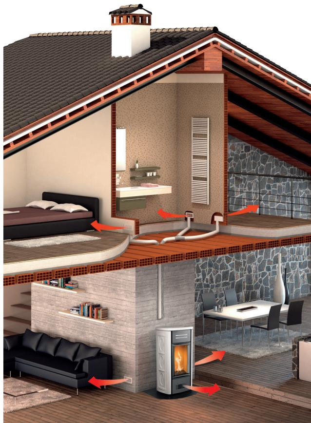
Système Multifuoco - L'air chaud est diffusé par des bouches obturables, de façon à régler la distribution selon ses besoins.
